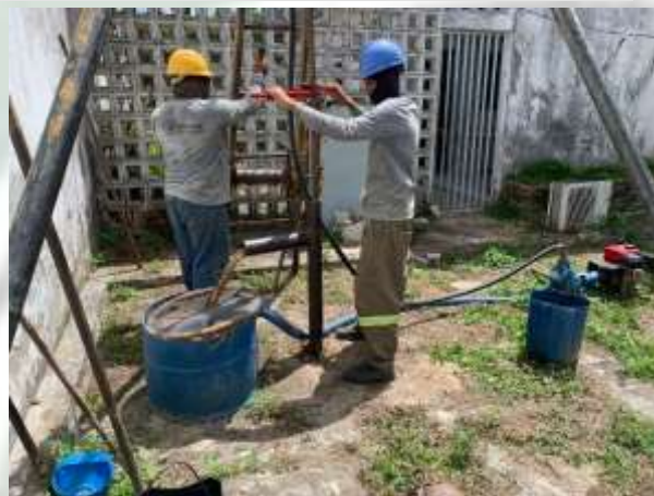
Foto 14 EXECUÇÃO DE SONDAGEM À PERCUSSÃO (SPT).
