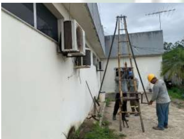
Foto 15 EXECUÇÃO DE SONDAGEM À PERCUSSÃO (SPT).
