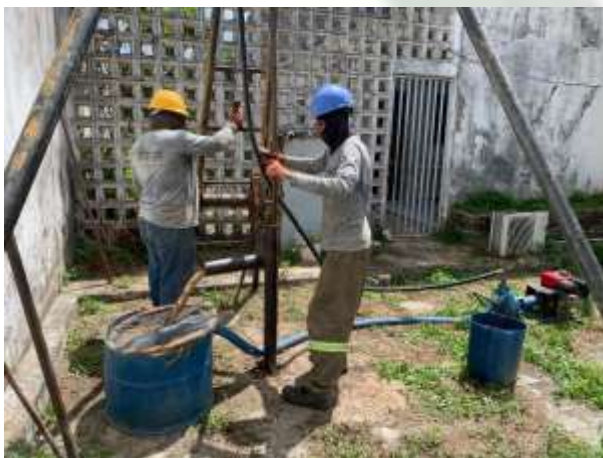
Foto 05 EXECUÇÃO DE SONDAGEM À PERCUSSÃO (SPT).
