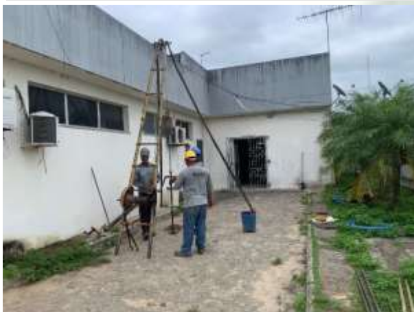
Foto 13 EXECUÇÃO DE SONDAGEM À PERCUSSÃO (SPT).
