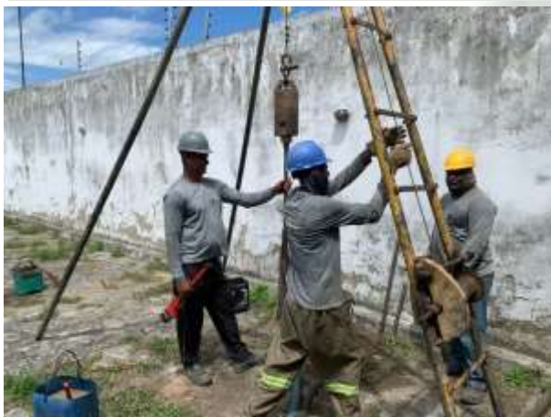
Foto 07 EXECUÇÃO DE SONDAGEM À PERCUSSÃO (SPT).
