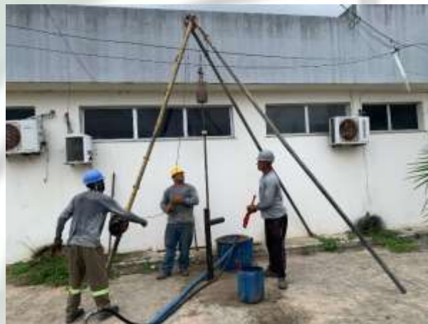
Foto 02 EXECUÇÃO DE SONDAGEM À PERCUSSÃO (SPT).
